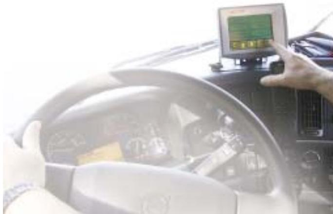
Abb. 7: Einbaubeispiel Bordrechner [Foto Max Bögl]
