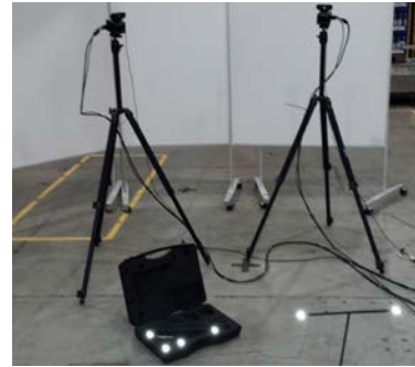
Abbildung 6. Trackingsystem des Demonstrators inklusive Kalibrierungstools
