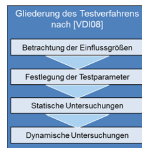
Abbildung 2. Gliederung des Testverfahrens nach [VDI08]
