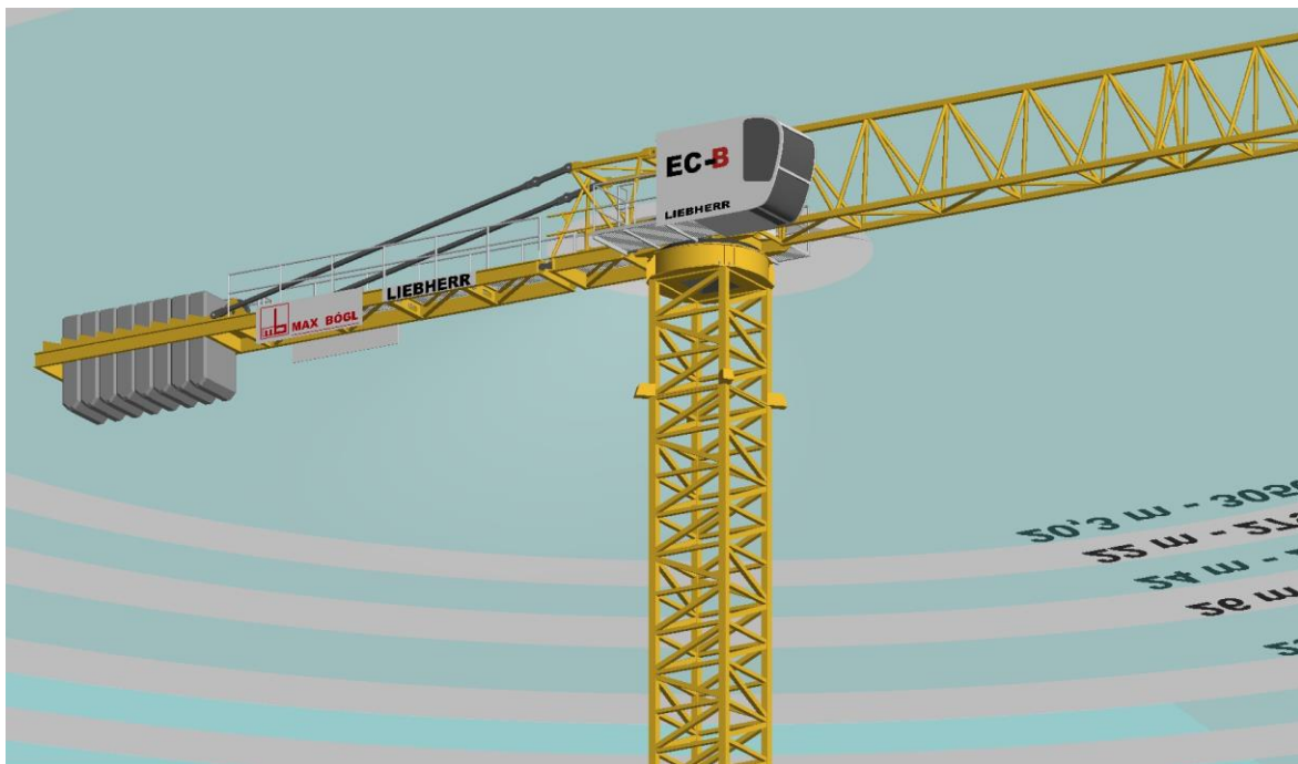
Bild 5: 3D-Baukranmodellierung im Turmdrehkran-Einsatzplaner
