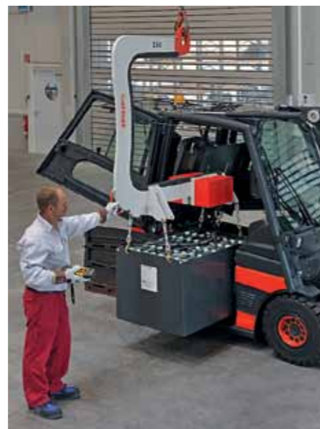
1 Batteriewechsel mit Kran bei einem Gabelstapler (Bild: Linde MH)
