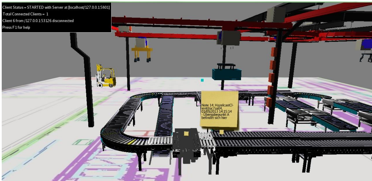
Abbildung 5. Darstellung eines Materialflusssystems mit zwei Subsystemen, Elektrohängebahn und Stetigförderanlage. In der Bildmitte wurde durch einen Benutzer des Kollaborationssystems eine Notiz erstellt, die den Übergabepunkt zwischen den Subsystemen markiert.
