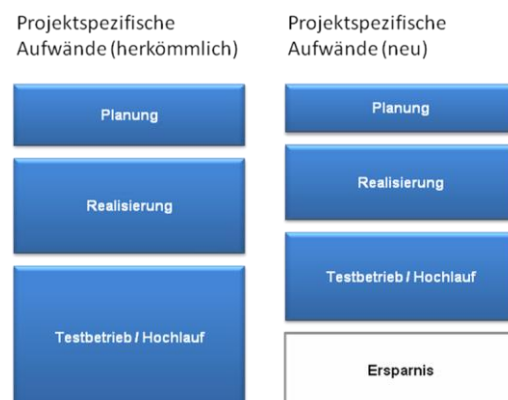
Abbildung 1. Vergleich der projektspezifischen Aufwände für Planung, Realisierung und Test bei Materialflusssystemen mit zentraler Steuerung (l.) und dezentral gesteuerten Anlagen (r.) ([KUZI0], S.9)
