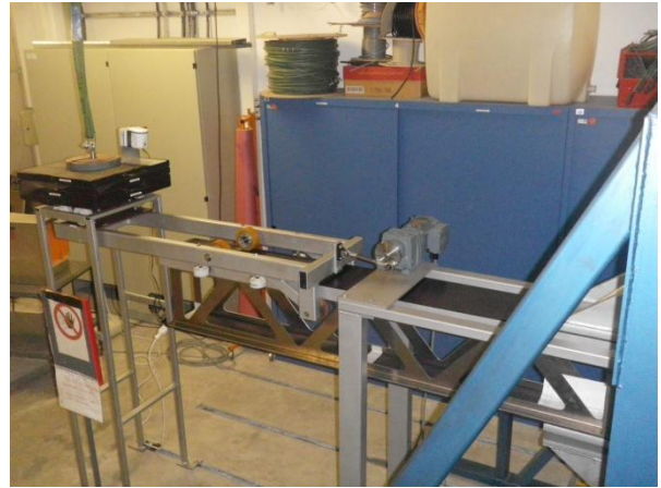
Abbildung 9: Dauerversuch zur Hubwagen-Rollenbelastung auf CFK (Quelle: fml)
