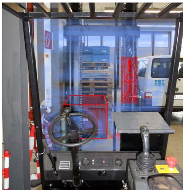
Abb. 2: Vision der optischen Hervorhebung einer Ladeinheit und Warnung vor einer in der Nähe befindlichen Person
